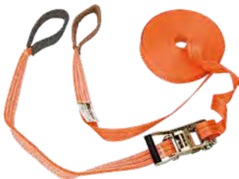
LÍNEA DE VIDA HORIZONTAL Fabricada en cinta de poliéster de 35 mm. Longitud máxima: 20 m. Usuarios: 2. Flecha máx: 1 m. 49,55 € + iva = 59,95 € Ref. 26.1254
