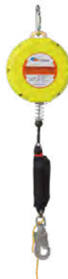
DISPOSITIVO ANTICAIDAS RETRACTIL 6 M CABLE CLIMAX Para uso VERTICAL Y HORIZONTAL. Provistos de frenado automático por inercia. Cable de acero galvanizado de 4,8 mm de diámetro y de 6 metros. Carga máxima: 120 kg. 189,26 € + iva = 229,00 € Ref. 26.1253
