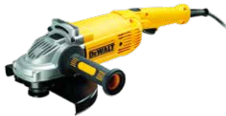
AMOLADORA DWE492-QS DEWALT 230 mm. 2.200 W. 6.600 rpm. Con arranque suave, inducido protegido contra la abrasión, empuñadura lateral de dos posiciones, botón bloqueo eje, ventana de cambio escobillas. 6.600 rpm, máx. diámetro de disco 230 mm, rosca M14, peso 5,2 kg.
