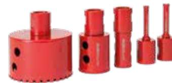
BROCA DRYGRES PREMIUM RUBI Para usar mediante amoladora. Para porcelánico, piedra natural y piedra sinterizada. Alta velocidad de perforación. 6-8-10-12-20-28-35-43 mm.
